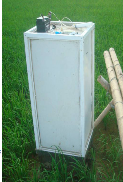
Hình 1: Hộp lấy mẫu khí làm từ vật liệu nhựa tráng nhôm và mica (hình hộp chữ nhật)
